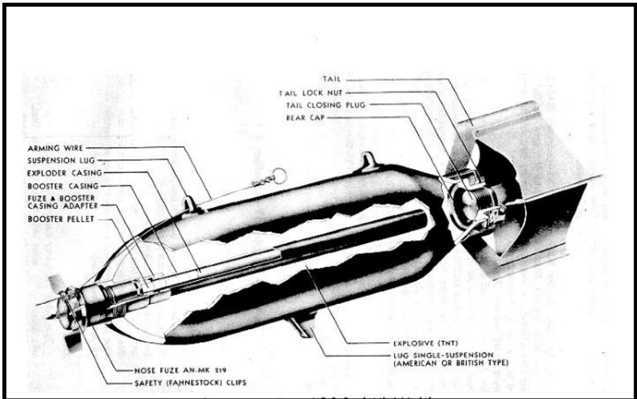
ILLUSTRAZIONE DELLA STRUTTURA DELLA BOMBA
